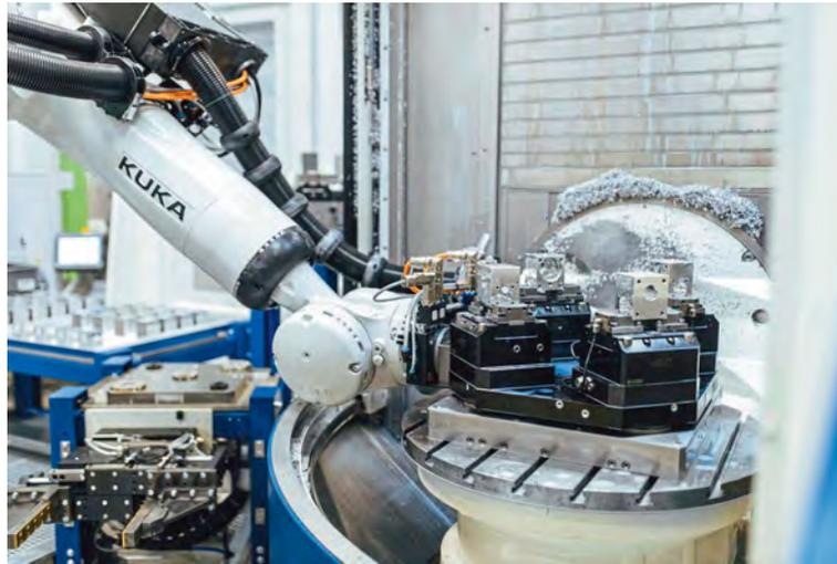
In dieser Anwendung wird der KUKA Roboter zur Bestückung der Fräsmaschine eingesetzt.
