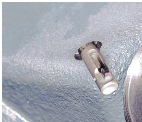
*Auch Gusseisenmaterialien mit sehr heterogenen Oberflächen (Gusshaut) sind mit dem BSF gut bearbeitbar. Die beschichteten Hartmetallmesser widerstehen der starken Belastung ohne Ausfälle und Störungen.*
