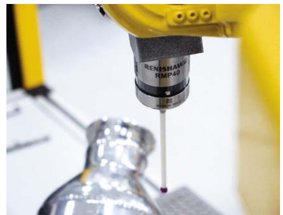
Werkstückmessung mittels eines in sechs Freiheitsgraden kalibriertem Funkmesstaster am Fanuc Roboter
