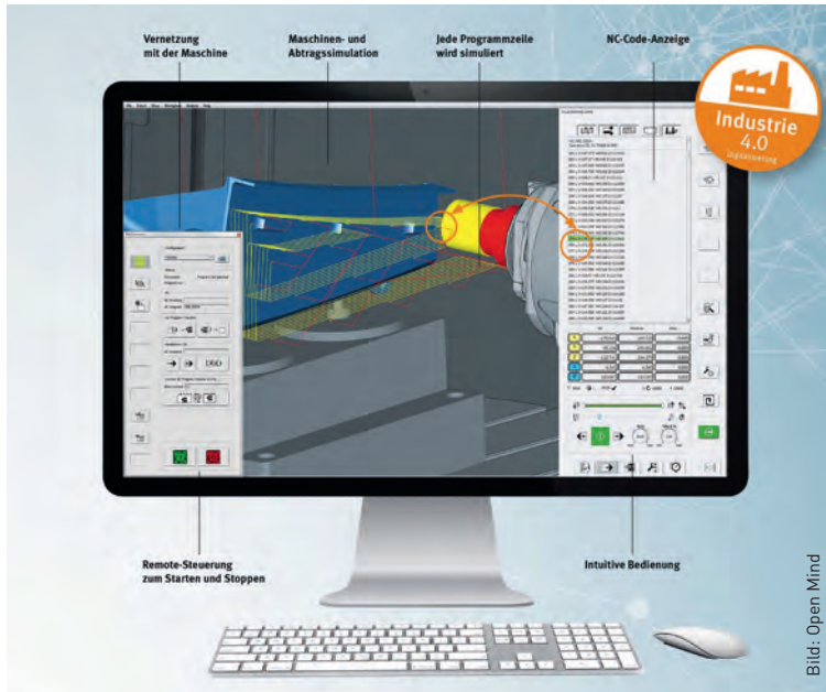
hyperMILL VIRTUAL Ma- chining: Simula- tion auf der Ba- sis von Echtzeit- Synchronisation.
