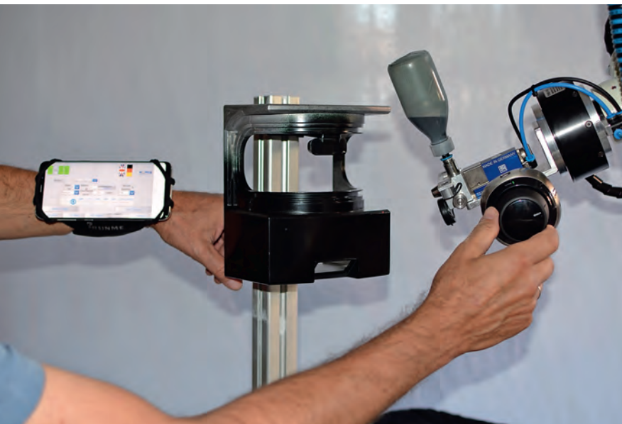
3D-Maus-Roboterführung: Ohne Kraftaufwand kann der Anwender komplexe Roboterbewegungen intuitiv einrichten.
