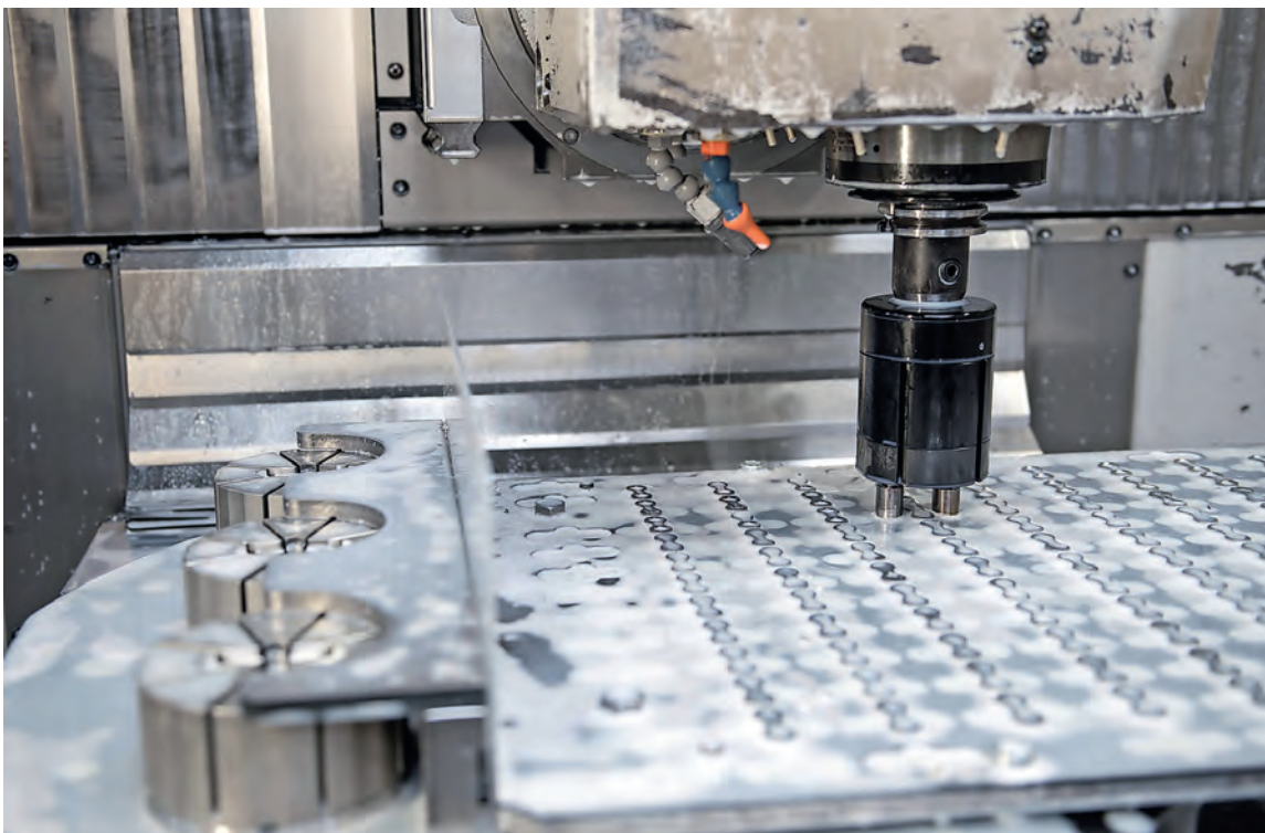
Der neue AMF-Greifer für die Werkzeugmaschine mit Weldon-Schaft wird wie ein Werkzeug vollautomatisch aus dem Magazin einer NC-gesteuerten Fräsmaschine eingewechselt.
