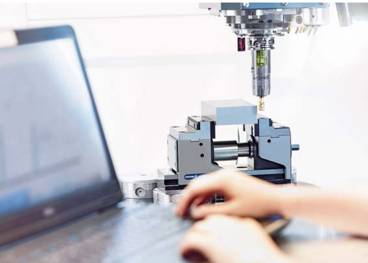
Der smarte iTENDO ermöglicht eine Echtzeitprozessüberwachung und -regelung unmittelbar am Werkzeug.
