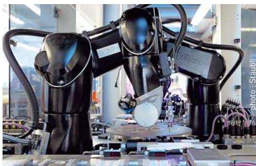
Deux robots six axes TX2-40 pour le tri et le contrôle qualité des aiguilles dans une cellule de 1,4 m 2 .
