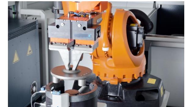
Gezieltes Positionieren der Werkstücke in einer Ausrichtstation oder in der Vorrichtung der Maschine
