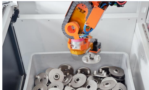
Geeigneter Greifer mit zusätzlichen Achsen zur kollisionsfreien Teileentnahme
