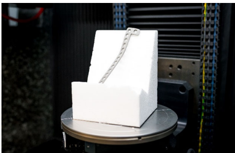
Knochenplatte im ZEISS METROTOM 6 scout
